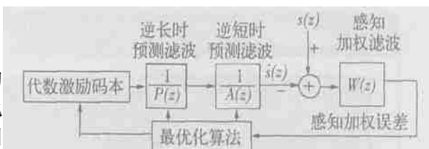
图 1 代数码的激励性预测算法原理图
