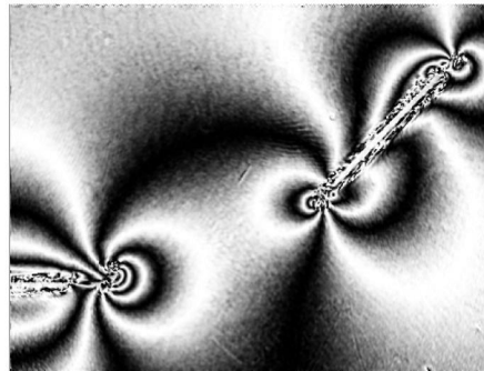
图10 水平裂纹与单个45° 的斜裂纹 Fig.10 A horizontal crack and a Oblique crack with 45 degrees
