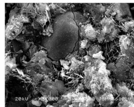
图7 W/C=0.35 28 d 基准混凝土渗后 Fig.7 28d benchmark concrete after soak W/C=0.35
