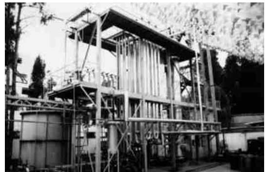
图 4 在昆明建成的 20 m 3 /d CWO 技术工业化应用装置
