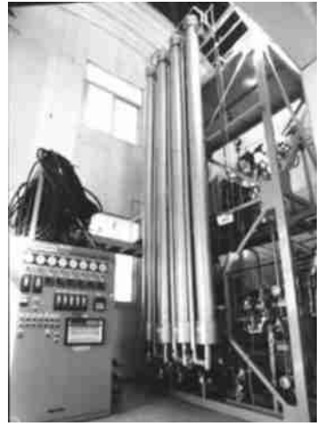
图 2 在昆明运行的 200L/d CWO 小型试验装置
