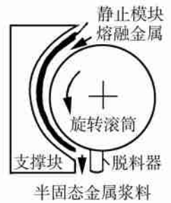
图 6 SCR 法的工作原理图
