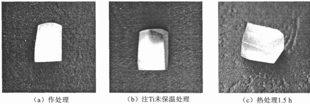
图2 注Ti样品处理前后表面颜色变化
